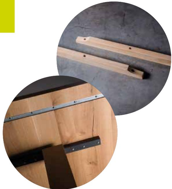
Beispiel: Wird eine Massivholzplatte auf ein Metallgestell montiert, muss durch eine Langlochbohrung sichergestellt werden, dass die Platte mehrere Millimeter arbeiten kann.
